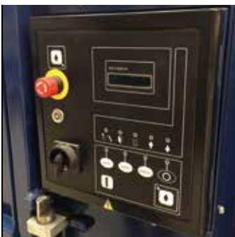
Modell E-03 er utstyrt med et oversiktlig kontrollpanel som bl.a. varsler når pressen er full og når det er tid for service.
