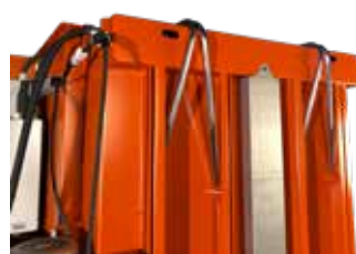
Rør for enkel ballstrøpping
