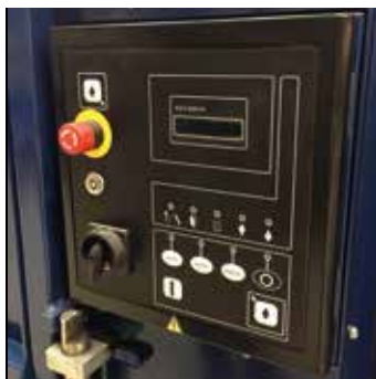
Modell E-01 er utstyrt med et oversiktlig kontrollpanel som bl.a. varsler når pressen er full og når det er tid for service.
