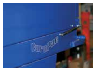
Frontdør er utstyrt med gassdempere.
