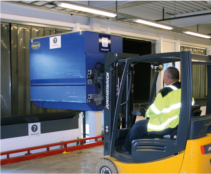
Postens terminalbygg på Østlandet benytter Binge Containerne til kildesortering av avfall i produksjonshallen. Når containerne er fulle, hentes de med truck og tømmes fra avfallsrommet direkte i komprimatorene som står på utsiden av anlegget.
