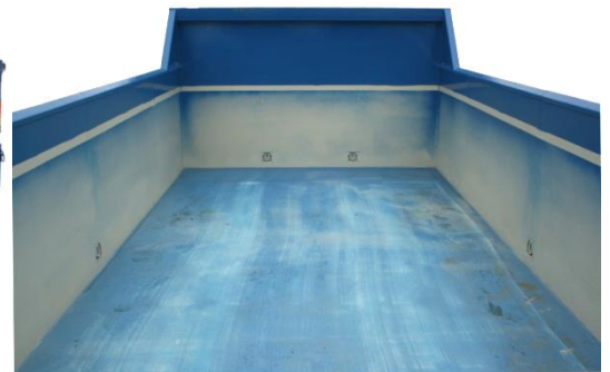
6 stk. leddet surrefester montert innvendig for transport av 8T gravere
